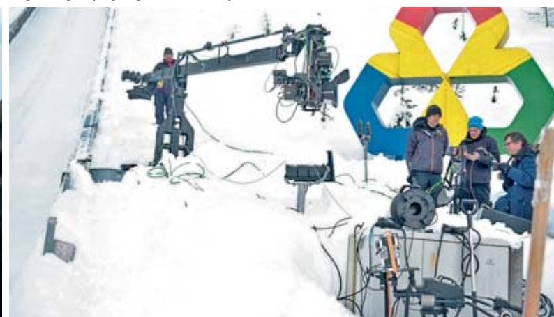
Light Weight Spiegelrig am Panther Foxy Kran © Ernst Kaufmann
